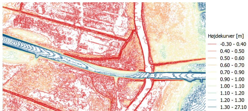
Figur 6 Nybro. Kotekurverne viser, at vejen har det laveste punkt i kote 1,36 m DVR90 vest for bro
