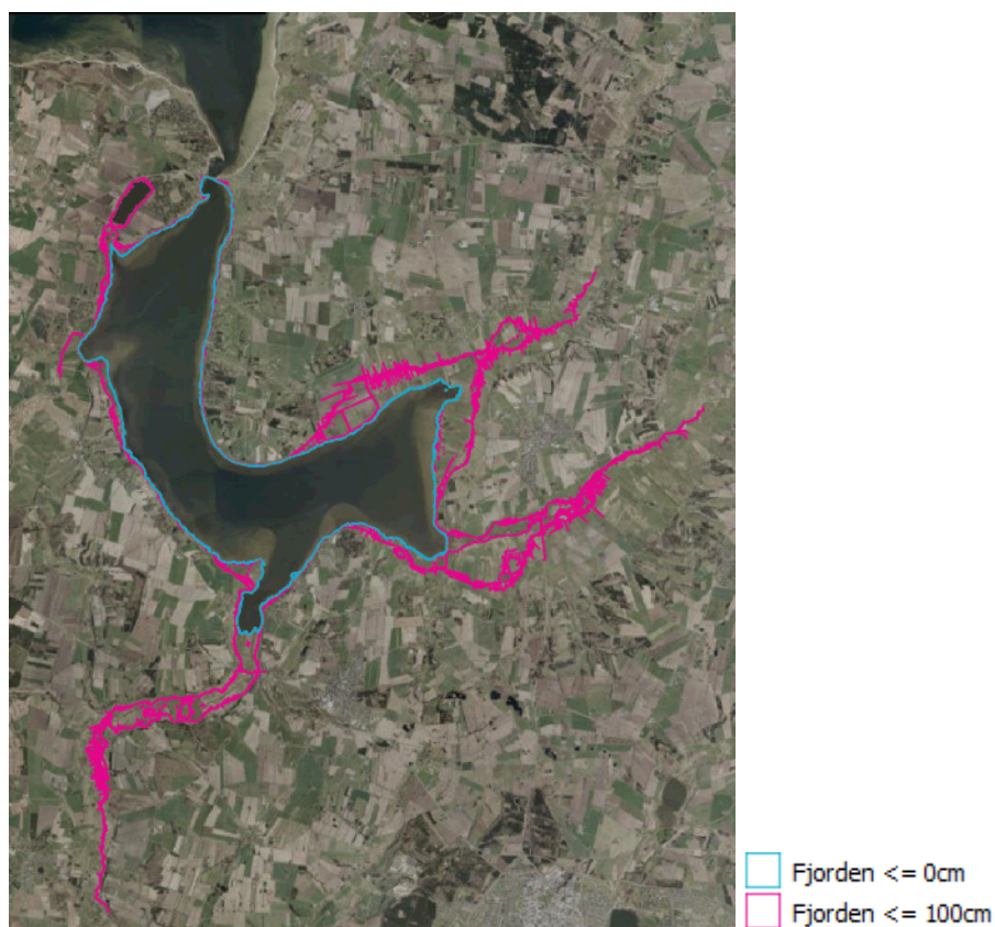
Figur 3 Overflade polygoner for Hjarbæk Fjord ved henholdsvis kote 0,00 m og 1,00 m DVR90.
